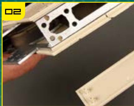
02 Два штифта, расположенные ближе к ребру SP-19, крепятся в крайние отверстия в раме.
